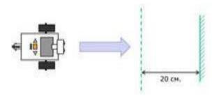
5. Парковка. Датчик расстояния смотрит в сторону. Робот должен найти пространство для парковки между двумя «автомобилями» и выполнить заезд в обнаруженное пространство.
