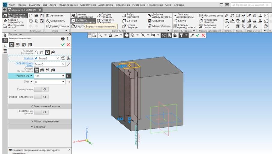
4. Нажимаем на зеленую галочку, чтобы построить отверстие. Чтобы посмотреть деталь с отверстием со всех сторон, можно зажать правую кнопку мыши и перемещать её по столу. Так модель будет производить вращения удобные вам для просмотра.
