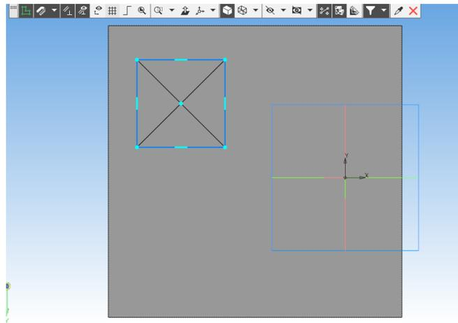
3. Выходим из эскиза (повторно нажать на кнопку «эскиз»). Выбираем элемент **Вырезать выдавливанием**. И в окне **Параметры** установить расстояние 100 мм (расстояние отверстия).
